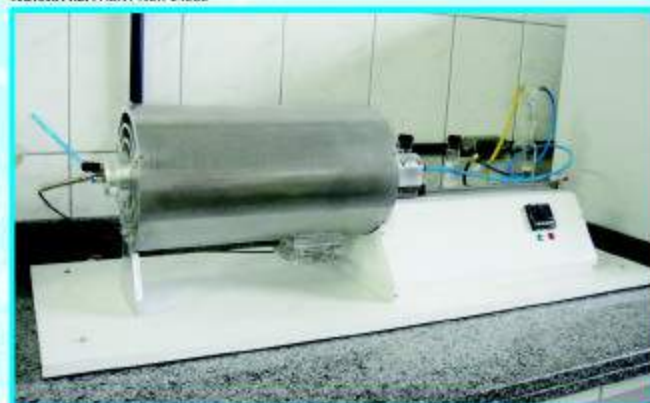
EQUIPAMENTO PARA DETERMINAÇÃO DO TEOR DE NEGRO DE FUMO EM CONEXÕES DE POLIPROPILENO: Permite a determinação do teor em massa de negro de fumo nas conexões pretas de polipropileno. NORMA REF: ABNT NBR 9058
