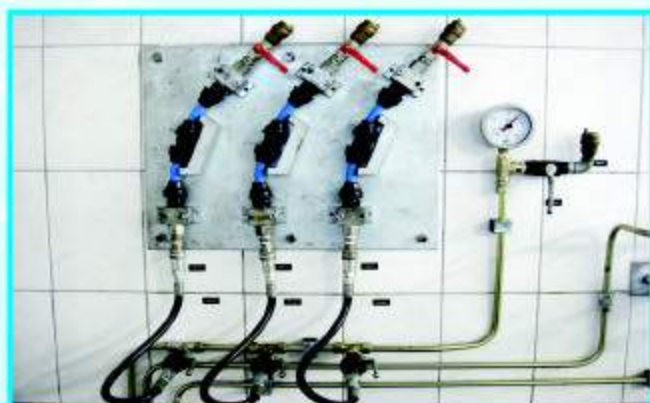
ESTANQUEIDADE DA JUNTA MECÂNICA COM TUBO CURVADO A FRIO (UNIÃO E ADAPTADOR): As conexões são submetidas à pressão negativa de (0,08 \pm 0,005) MPa e em seguida à pressão hidrostática interna de 2,4 MPa. NORMA REF: ABNT NBR 9056 / NBR 15803 / NTS 179 (SABESP) / IT OPE 820 (SANEPAR)
