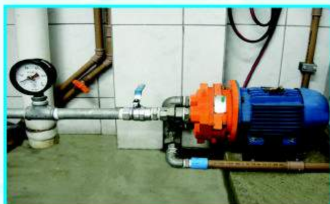
BOMBA DE VÁCUO: Permite que as conexões sejam submetidas à pressão negativa (vácuo) de (0,08 \pm 0,005) MPa.
