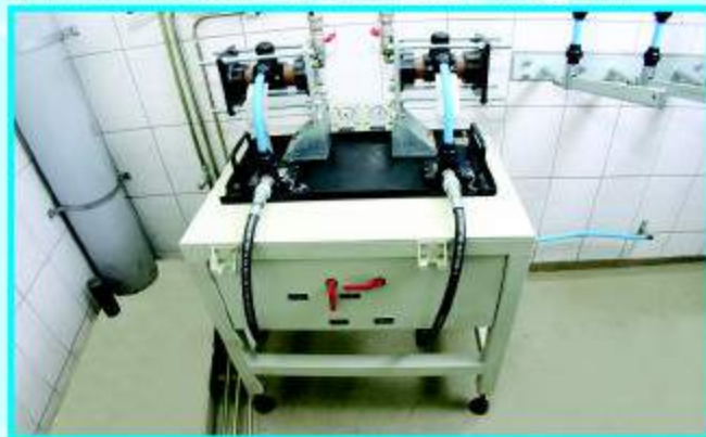
TUBO CURVADO A FRIO (TE DE SERVIÇO INTEGRADO): As conexões são submetidas à pressão negativa de (0,08 \pm 0,005) MPa e em seguida à pressão hidrostática interna de 2,4 MPa. NORMA REF: ABNT NBR 9056 / NTS 175 (SABESP) / IT OPE 820 (SANEPAR)
