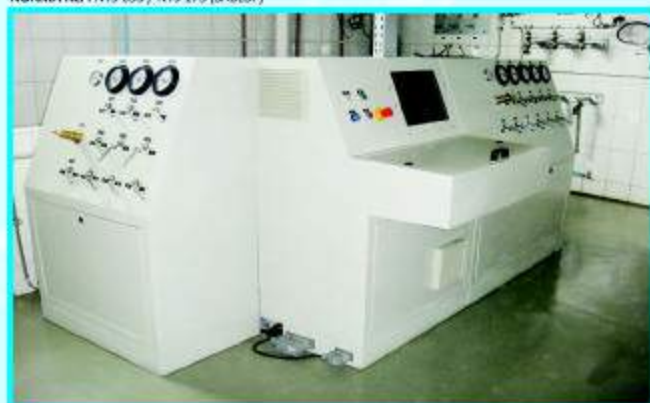
PAINEL DE CONTROLE DOS ENSAIOS DE ESTANQUEIDADE: Permite o controle de todos os pontos de pressão proporcionando agilidade e rapidez nos ensaios de qualidade das conexões.
