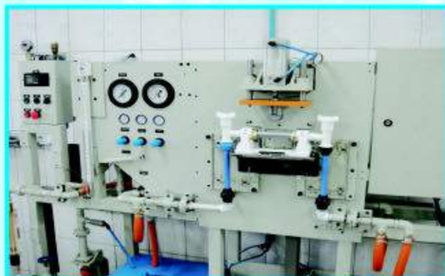
BANCADELA AUTOMÁTICA PY ENSAIOS DE PRESSÃO HIDROSTÁTICA / COMPRESSÃO E PERDA DE CARGA EM KIT CAVETE: Permite que os cavetes para rimel perfil e os cavetes padrão UVIC sejam submetidos aos ensaios de pressão hidrostática interna, compressão (teste de esforço) e perda de carga de forma rápida e prática. NORMA REF: ABNT NBR 10805 / 10806 / 10807
