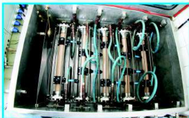
ENSAIO DE 100 E 1000 HORAS (TE DE SERVIÇO INTEGRADO): O Te de Serviço passa pelo ensaio de longa duração onde é submetido à pressão hidrostática interna de 1,3 MPa durante 1000 horas e a temperatura de 40±2 °C. Também é submetido ao ensaio de curta duração quando recebe 2,4MPa de pressão hidrostática interna durante 100 h e a temperatura de 20±2 °C. NORMA REF: NTS 053 / NTS 175 (SABESP)
