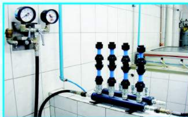
ENSAIO DE 100 E 1000 HORAS (ADAPTADOR E UNIÃO): O Adaptador e União são submetidos à pressão hidrostática interna de 2,4MPa por 100 horas à temperatura de 20±2 °C. Também passa pelo ensaio de longa duração onde é submetido à pressão hidrostática interna de 1,3 MPa durante 1000 horas e a temperatura de 40±2 °C. NORMA REF: NTS 053 / NTS 179 (SABESP)
