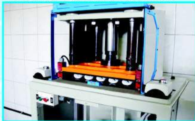
08 - ENSAIO DE ACHATAMENTO: As conexões de PVC são submetidas a um esforço de compressão onde resistem a uma deflexão de 20% de seu diâmetro maior. NORMA REF: ABNT NBR 5648 / 6483
