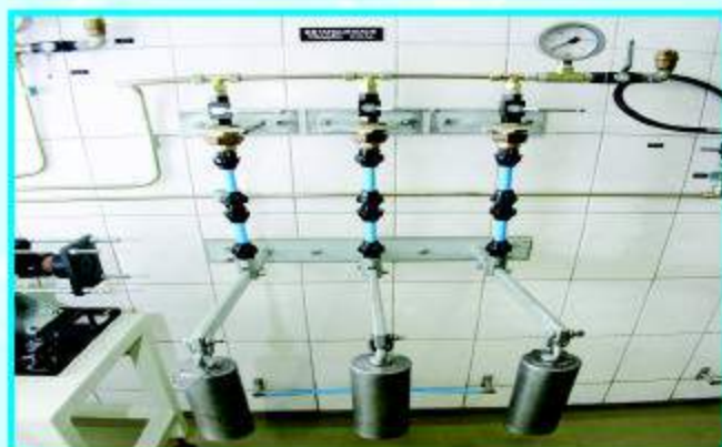
RESISTÊNCIA AO ESFORÇO DE TRAÇÃO AXIAL (UNIÃO E ADAPTADOR): As conexões são submetidas a um esforço axial de 1200 N e ao mesmo tempo recebem pressão hidrostática interna de 2,4 MPa. NORMA REF: ABNT NBR 9057 / NBR 15803 / NTS 179 (SABESP) / IT OPE 820 (SANEPAR)
