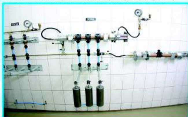
RESISTÊNCIA AO ESFORÇO DE TRAÇÃO AXIAL (TE DE SERVIÇO INTEGRADO): As conexões são submetidas a um esforço axial de 1200 N com pressão hidrostática interna de 2,4 MPa. NORMA REF: ABNT NBR 9057 / NBR 15803 / NTS 179 (SABESP) / IT OPE 820 (SANEPAR)
