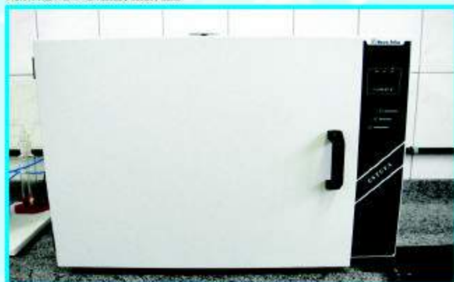
ESTUFA CLIMATIZADA PARA ENSAIOS DE COMPORTAMENTO AO CALOR: Permite que as conexões passem pelo ensaio de comportamento ao calor à temperatura especificada. NORMA REF: ABNT NBR 9799
