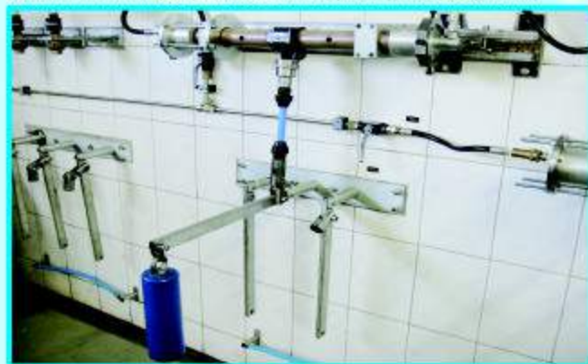
RESISTÊNCIA À TRAÇÃO RADIAL (TE DE SERVIÇO INTEGRADO): As conexões são submetidas ao esforço de tração radial de 1200 N aplicado à tampa da ferramenta de corte com pressão hidrostática interna de 2,4 MPa. NORMA REF: ABNT NBR 10931 / NBR 15803 / NTS 179 (SABESP) / IT OPE 820 (SANEPAR)
