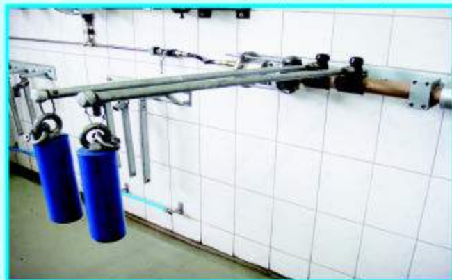
RESISTÊNCIA À TORÇÃO (TE DE SERVIÇO INTEGRADO): As conexões são submetidas ao esforço de tração torção de 44 N.m aplicado em sua derivação com pressão hidrostática interna de 2,4 MPa. NORMA REF: ABNT NBR 10931 / NBR 15803 / NTS 179 (SABESP) / IT OPE 820 (SANEPAR)
